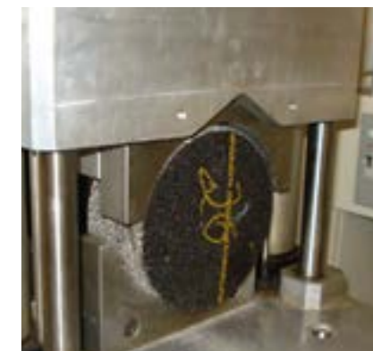
6 Qualitätssicherung / Prüfung des Schichtverbundes
