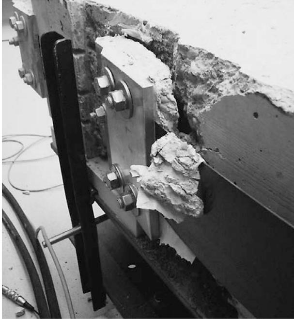
Bild 14: Beschädigter Beton
