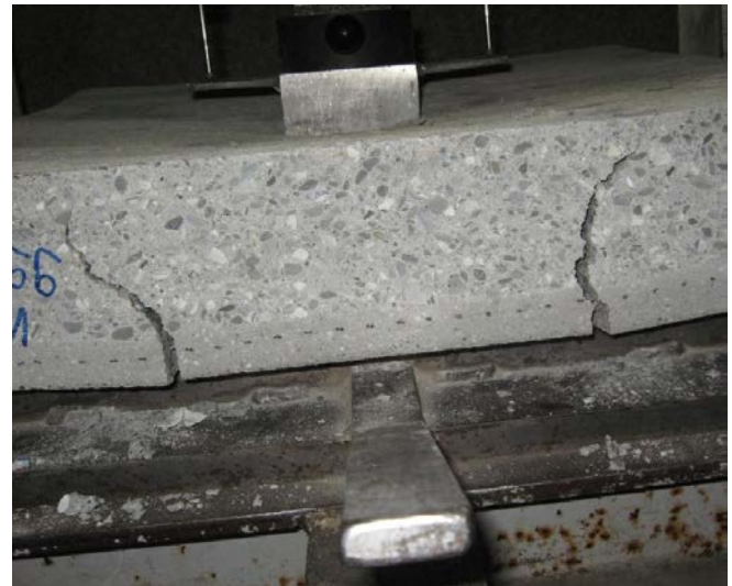
Bild 8: Prüfling VSH im Bruchzustand
