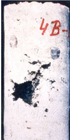
Bild 13: Spritzschatten hinter Stahlbewehrung
