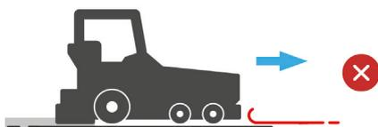
Querüberlappungen sind so anzuordnen, dass sie vom Asphaltfertiger nicht hochgeklappt werden können.
